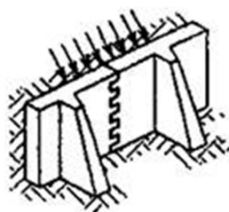
Рисунок 3 - Растяжение кладки при изгибе по перевязанному сечению
